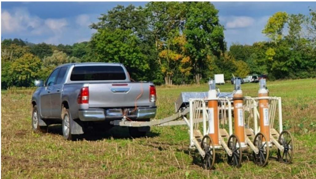
*Abbildung 1: SQUID-basiertes Messsystem JESSY SMART der Supracon AG im Feldeinsatz zur Drainagedetektion*
